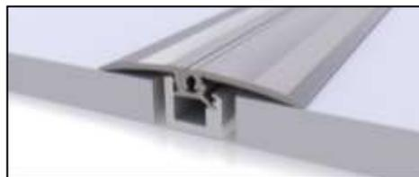
Les conditions d'humidité relative et de température peuvent varier d'une saison à l'autre et il est vital que le revêtement de sol puisse se dilater ou se rétracter dans toutes les directions. Ce profilé permet au sol de bouger librement.
